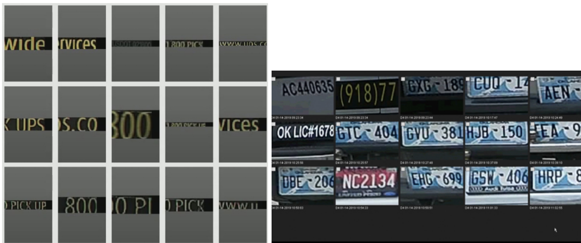
Rys. 3. Porównanie różnych umiejscowień kamery: błędnego z poprawnym
